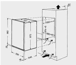
Belüftung im Sockelbereich min. 200 cm²; Entlüftung oben min. 200 cm²
